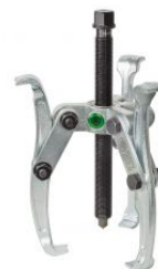
Extractor de rodamientos combinado de 3 patas reversibles
