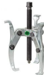
Extractor de rodamientos combinado de 3 patas reversibles
