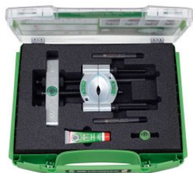
Juego con separador de rodamientos standard
