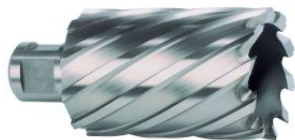
Broca hueca HSS con vástago Weldon y profundidad 55 mm at.com.es/p/1017929
