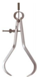
Compás de exteriores con muelles y ajuste rápido
