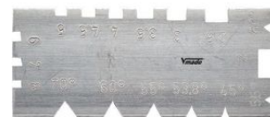
Patrón para ángulos de roscas combinado
