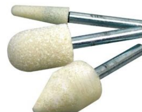
Muelas con vástago Ø 6 mm de corindón blanco para acabados en acero y acero inox at.com.es/p/1018530
