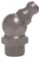
Engrasadores hidráulicos 45° DIN 71412 tipo H2 at.com.es/p/1018709
