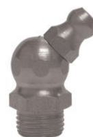
Engrasadores hidráulicos 45° DIN 71412 tipo H2
