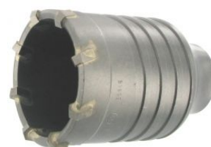
Corona con conexión cónica 1/8 para fuerzas de impacto superiores a 900W y profundidad útil de 75 mm at.com.es/p/1019074
