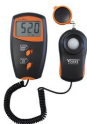
Medidor de intensidad luminosa electrónico digital at.com.es/p/1019009
