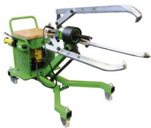
Extractor de rodamientos hidráulico móvil "GOLIATH"
