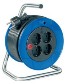
Enrollacables Garant® compacto IP20 H05VV-F 3G1,5 para uso doméstico
