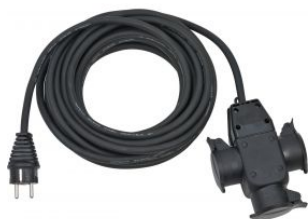
Alargador eléctrico IP44 H07RN-F 3G1,5 con cabezal de goma de 3 tomas para industria y obras at.com.es/p/1020010
