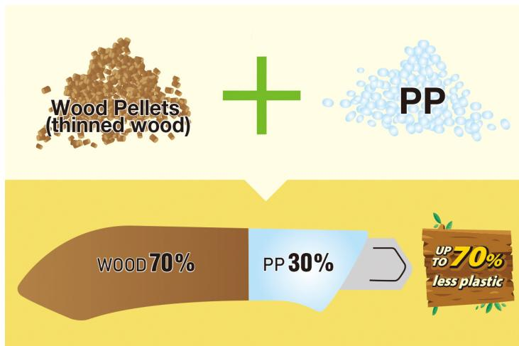
La resina utilizada en la fabricación del mango se mezcla aproximadamente con un **70% de madera de pellets**.
